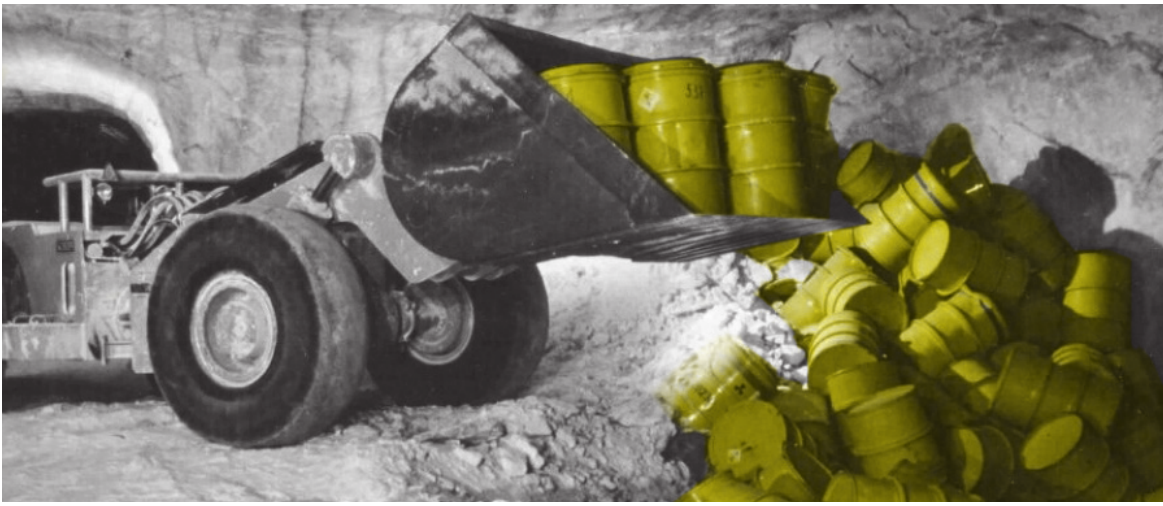
„Sichere“ Endlagerung mittels der sog. Versturztechnik im Atommüllendlager Asse bei Wolfsbüttel.
